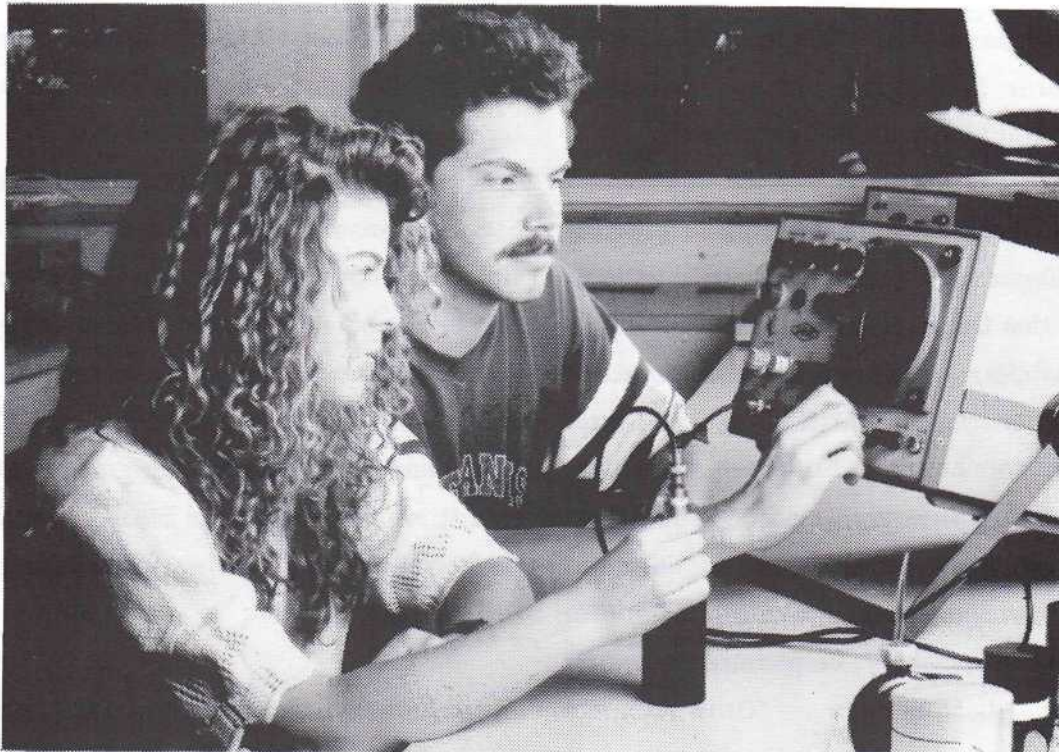
Fehlersuchtrupp im WET-Labor Zerstörungsfreie Werkstoffprüfung mit Ultraschall
