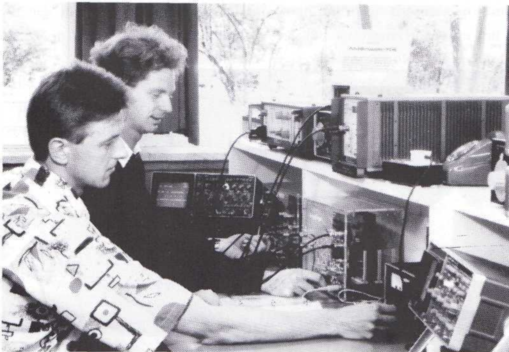
Einer der sechs Laborversuche des Praktikums "Einführung in die Telekommunikation": Messungen an einem digitalen Übertragungssystem mit Puls-Code-Modulation und einer Bitrate von 2,048 Mbit/s
