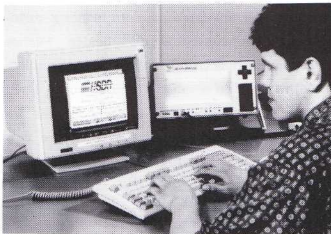
Programmieren des ISDN-Controllers und Beobachten des D-Kanal-Protokolls mit Hilfe des ISDN-Analysators
