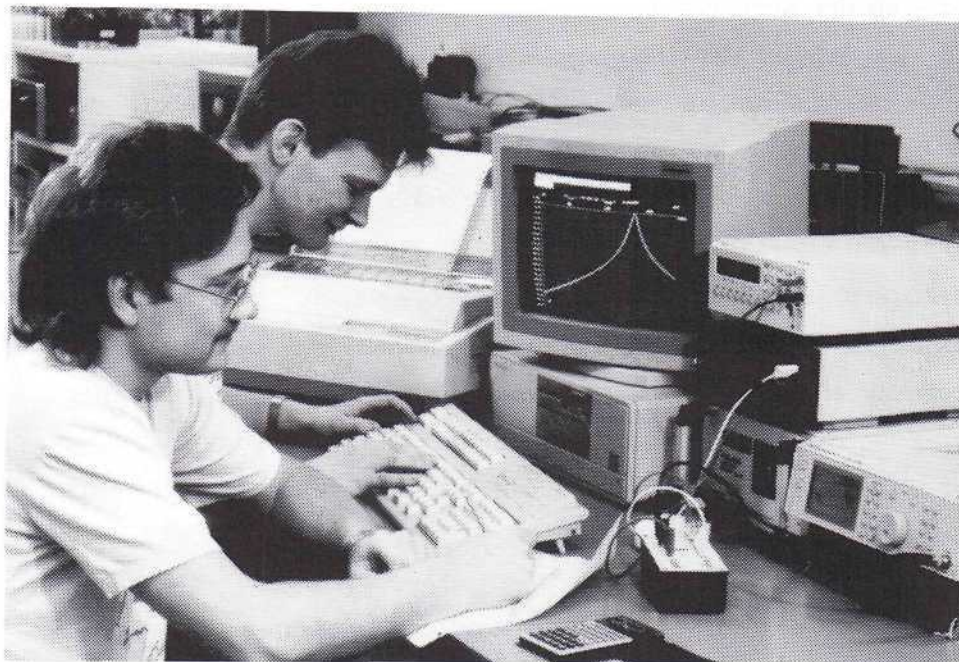
Diskussion der Übertragungsfunktion eines Filters, automatisch aufgenommen mit einem PC
